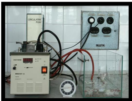
**Рис. 1:** Емкость для проведения опыта с водой 37°C.
