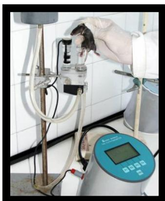
**Рис. 2:** Прибор (плетизмометр) для измерения объема ног.
